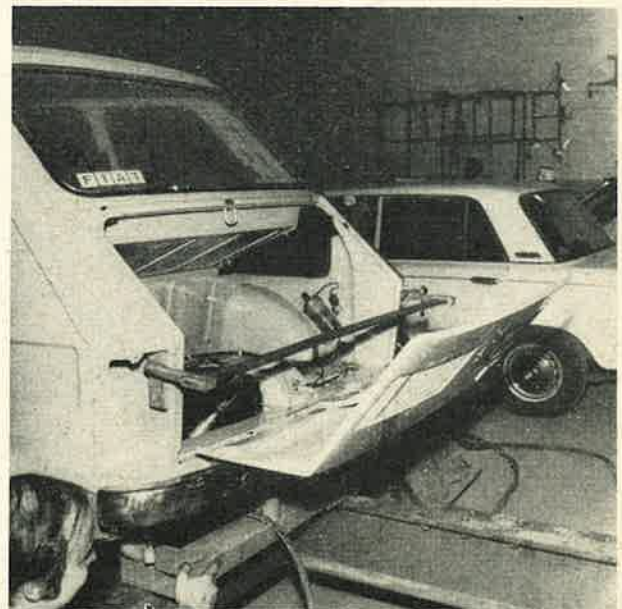
Fig. 28. — Pendant que l'on actionne le vérin pour la mise en place correcte de l'attache sur le montage (24), il est nécessaire de maintenir, à l'aide d'un serre-joint, l'écartement correct des panneaux du compartiment-moteur (photo R.T.C.).
