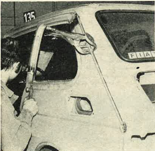
Fig. 45. — Soudage bord à bord (soudure oxyacétylénique) à la liaison des éléments neufs et conservés : encadrement de baie de custode - pied d'entrée de porte (photo R.T.C.).
