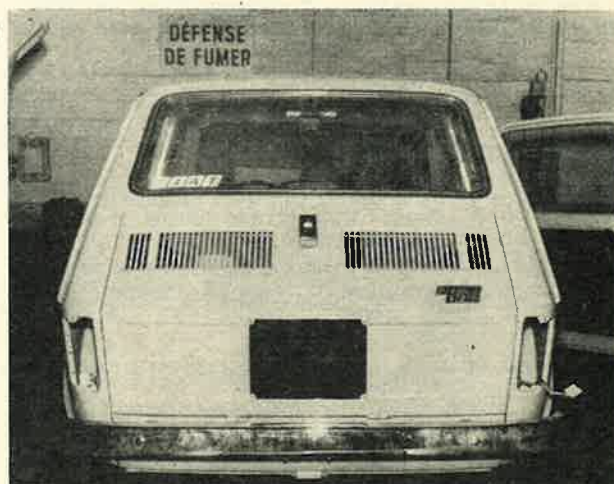
Fig. 41. — Mettre en place le capot du compartiment moteur et la traverse arrière, afin de contrôler les jeux (photo R.T.C.).
