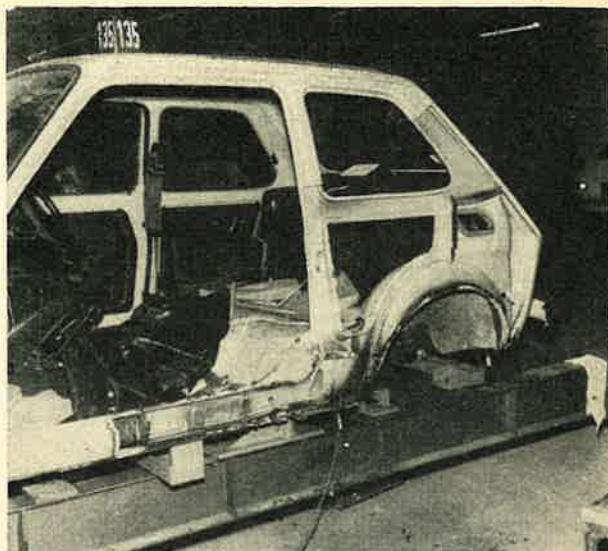
Fig. 30. — Découpe préliminaire de l'élément accidenté (photo R.T.C.).
