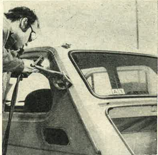
Fig. 46. — Soudage bord à bord à la liaison : entourage de baie de custode (photo R.T.C.).
