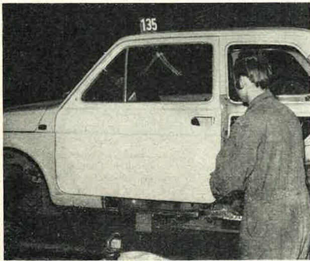
Fig. 32. — Après redressage des éléments conservés, présentation de la porte neuve servant de gabarit (photo R.T.C.).
